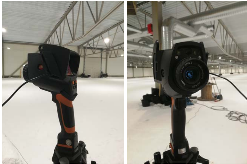
Figure 23: Thermal camera, Testo 875i.
